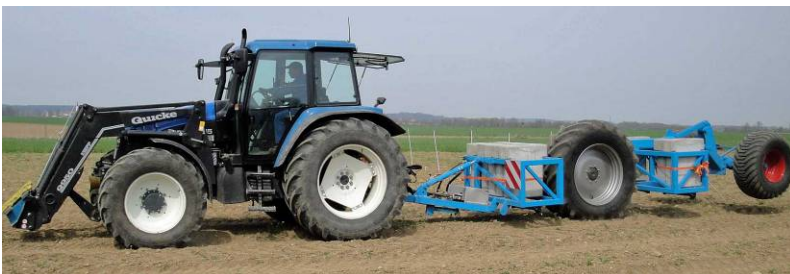
Anlegen eines Belastungsversuches mit dem Belastungswagen mit 4,6t Radlast und angepasstem Reifeninnendruck von 1,6 bar. © LfL, Foto: M. Wild
